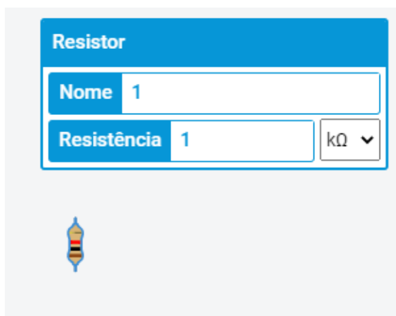
Figura 3.6: Configurações para resistor: pode-se mudar o nome, valor da resistência (canto inferior esquerdo) e a escala (canto inferior direito).
