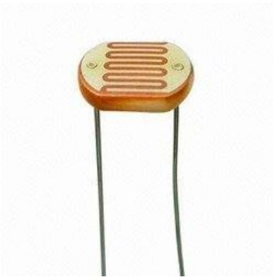
Figura 6: Sensor de luminosidade LDR.
